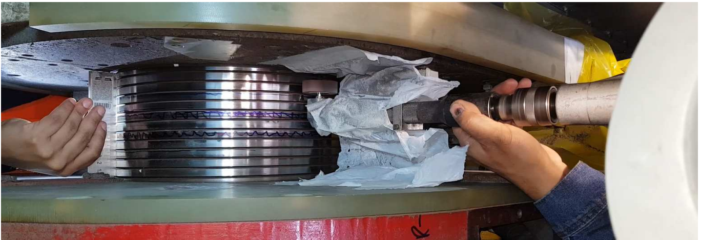
Detalle del maquinado (rectificado con equipos SUHNER)
